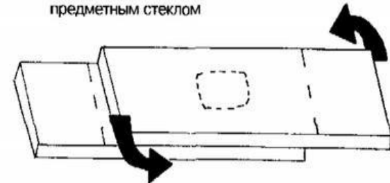
Стёкла прижимают и вращают друг против друга
